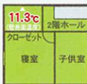
結露とは、温度が低いところに水蒸気が触れ、「水」になる現象です。そのため、断熱性能を高めること、そして室内の湿度を高くすぎないことが、「結露・カビ」対策のポイントです。断熱性能が高い家では、クローゼットの北壁の表面温度が2.8°Cまで下がり、「結露・カビ」の発生する要因であることがわかります(上図)。
