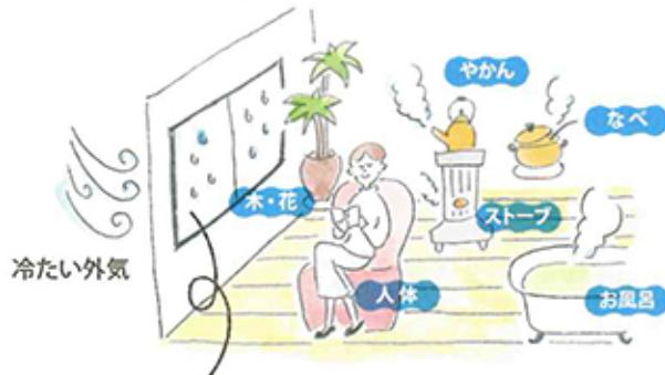
窓の表面温度が露天温度(\*)より低いとき、窓の表面に結露が発生します
