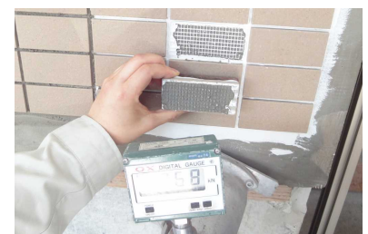
④ 変性シリコン系ボンド 2.68kN
