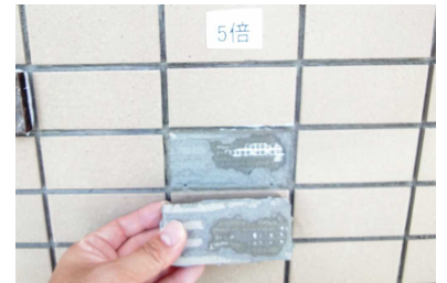
② ダブルワンP1+ ハイフレックス5倍液 3.18kN
