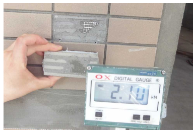
③ ダブルワンP1+ ハイフレックス10倍液 2.1kN
