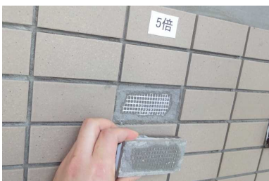
② ダブルワンP1+ ハイフレックス5倍液 2.36kN
